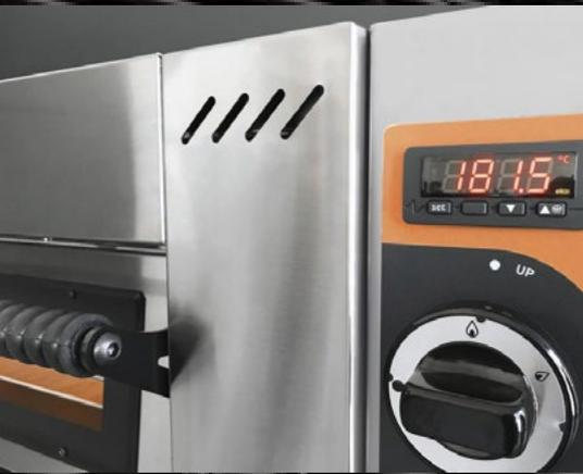
Gas Cúpula con alimentación de gas natural y GPL. Cúpula especial de inox cuya finalidad es la de sustituir al horno de leña. Distribución del calor uniforme y constante.
