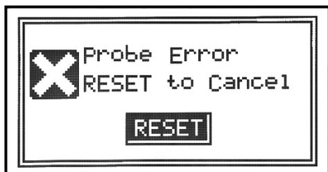
Si la sonda no está conectada o tiene un mal funcionamiento contrólela y luego presione ENTER para reiniciar.
